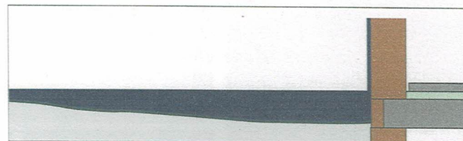
Abb. 7: Die Geländegestaltung ist entscheidend, wie stark die Wassereinwirkung an Sockelzonen ist. Wird die Geländeoberfläche nicht vom Gebäude weg geneigt, ist mit zumindest temporären Geländeoberflächenüberflutungen und damit mit unnötig hohem Druckwasser an der Sockelzone zu rechnen.
